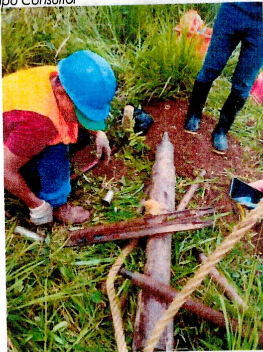
Fotografía 3-4: Ensayo SPT, recuperación de muestras Fuente: Elaborado Equipo Consultor
